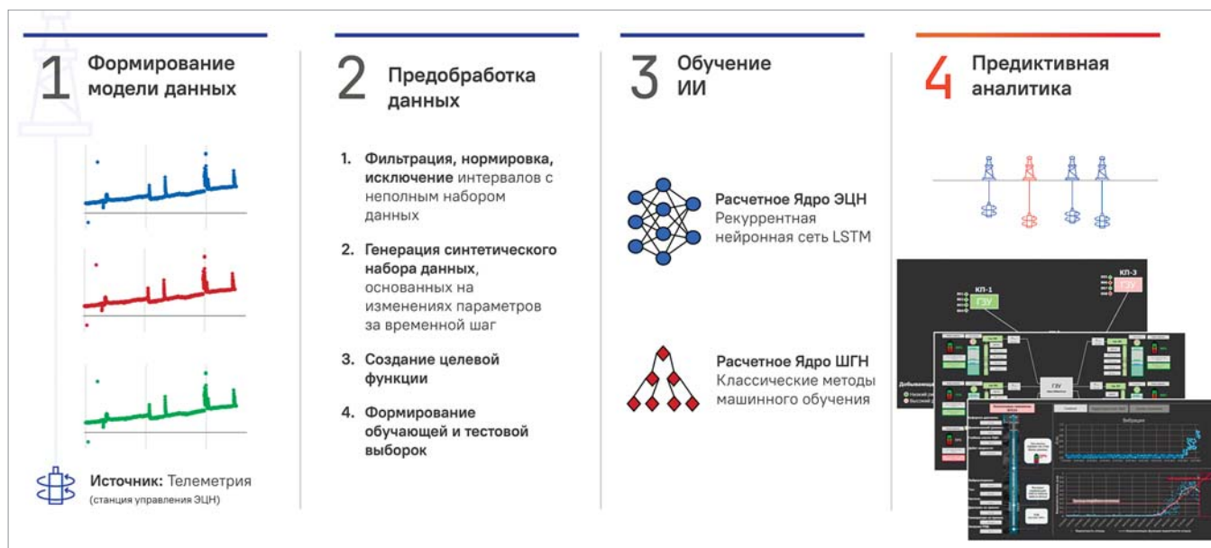
Рис. 1. Принципиальная схема технологии предиктивной аналитики
