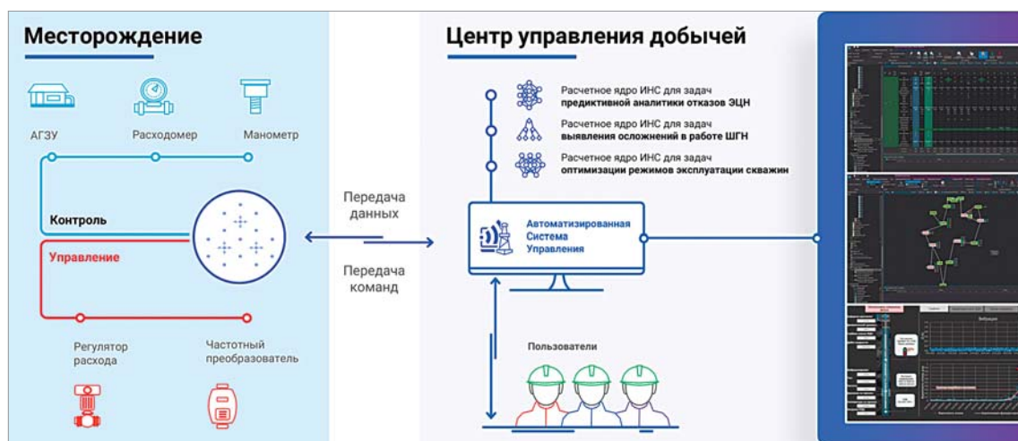
Рис. 8. Концепция управления промыслом на основе алгоритмов машинного обучения
